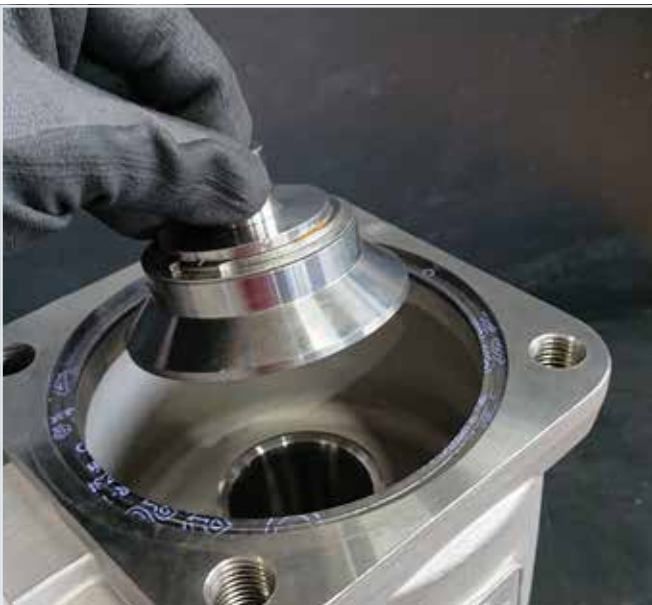
7.9 Kegelbaugruppe mit eingelegter gefetteter Kugel auf Sitz setzen.
