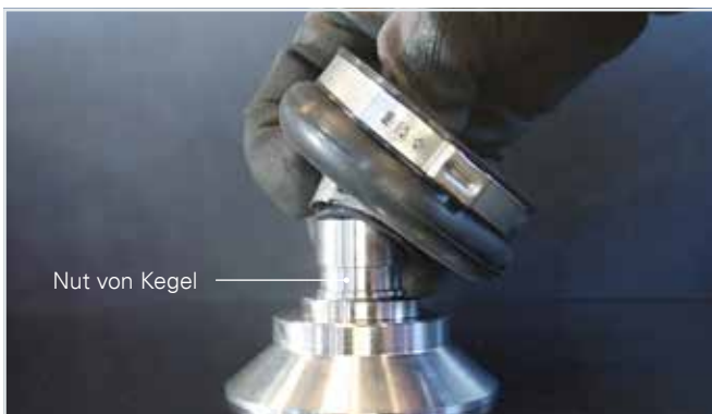
5.11 Ohr-Schellen in äußere Nut von Elastomerbalg setzen.
