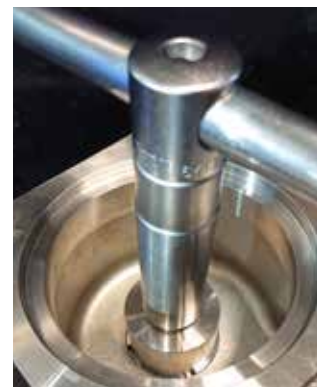
Einschrauben des Sitzes in das Gehäuse.
