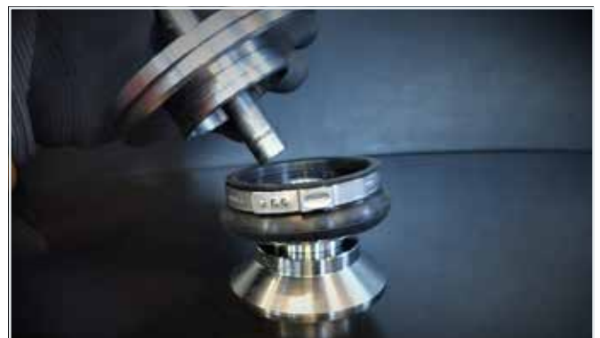
5.14 Bohrungsgrund von Kegel mit etwas Edelstahl-Fett bestreichen und Kugel einlegen.
