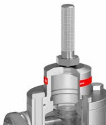
Abbildung 10: Die Spindel ist frei und die Kappe ist gasdicht verschlossen
