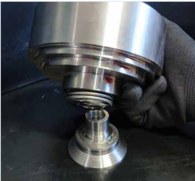
7.14 Spindel in Kegel mit eingelegter gefetteter Kugel stecken.
