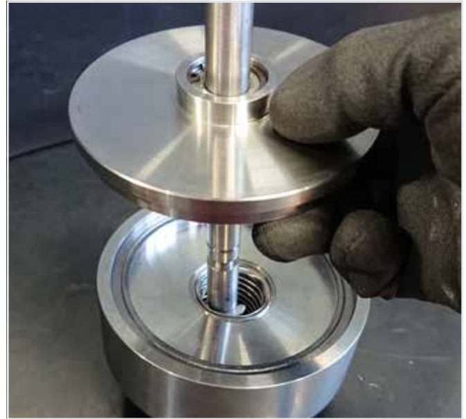
7.13 Führungsplatte und Federteller auf der Spindel montieren.
