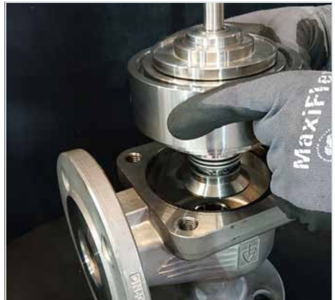
7.15 Spindelbaugruppe mit montierter Kegelbaugruppe vorsichtig auf eingeschraubten Sitz setzen.
