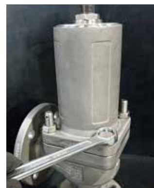
Verschraubung von Haube und Gehäuse.
