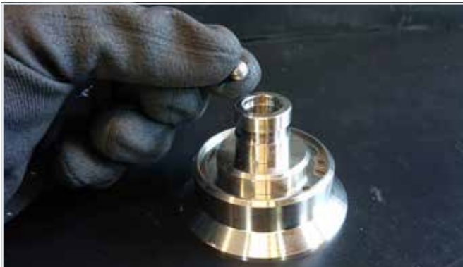
4.10 Bohrungsgrund von Kegel mit etwas Edelstahl-Fett bestreichen und Kugel einlegen.
