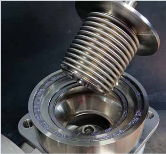
7.11 Spindel in Faltenbalggruppe stecken.
