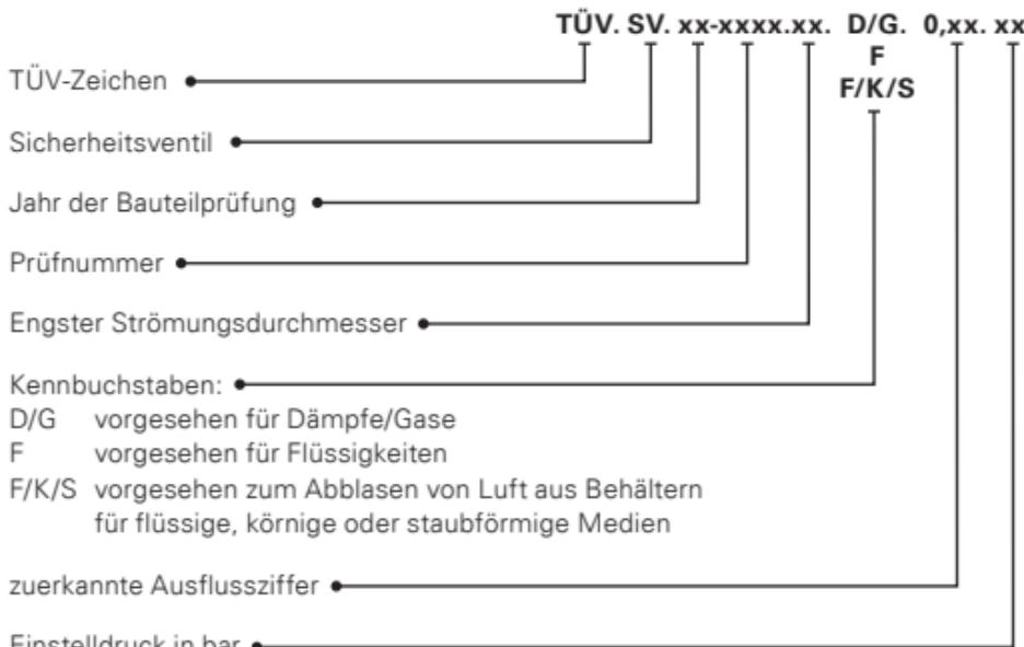
Alle Ventile werden von uns auf Druckfestigkeit und Dichtheit geprüft.
