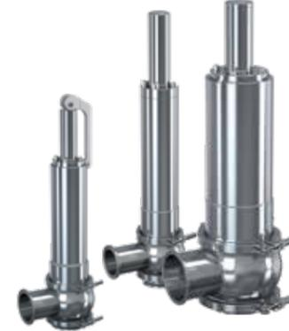
Die Baureihe 4100, ein Sicherheitsventil entwickelt für die Getränke- und Brauindustrie, kombiniert ein flüssigkeitsoptimiertes, hygienisches Design mit hoher Effizienz und Betriebssicherheit. Die kompakte Bauweise mit identischen Ein- und Austrittsöffnungen reduziert Installationskosten und ermöglicht durch die Verfügbarkeit bis DN100 eine flexible Systemintegration.
