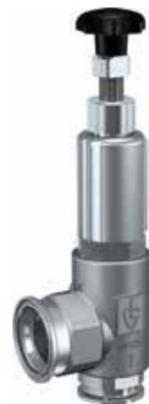
Die einstellbaren hygienischen Überströmventile der Baureihe 453 zeichnen sich durch einen gegendruckkompensierenden Edelstahl-Faltenbalg aus. Dies stellt sicher, dass ein auf der Austrittsseite wirkender Gegendruck die Effizienz und Funktionalität des Ventils nicht beeinträchtigt.
