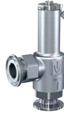
Les déverseurs et soupapes de réglage des séries 417 et 418 conviennent à la protection des pompes. En outre, les soupapes sont optimales pour la décharge de pression et la régulation de réservoirs et de citernes (par ex. superposition de CO<sub>2</sub>) et optimales pour la décharge de pression de systèmes de tuyauterie fermés. En effet, le fluide qui s'échappe peut être évacué ou ramené de manière contrôlée.
