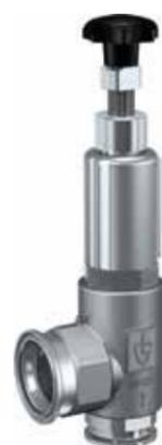
Les soupapes de décharge hygiéniques réglables de la série 453 se caractérisent par un soufflet en acier inoxydable qui compense la contre-pression. Cela garantit qu'une contre-pression agissant du côté de la sortie n'affecte pas l'efficacité et la fonctionnalité de la soupape.
