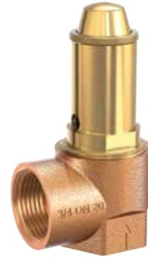
Cette soupape de sûreté en bronze est une alternative à bas prix aux soupapes de sûreté hautes performances, lorsque des débits plus petits suffisent. La version 652mFK pour liquides neutres est idéale pour protéger les pompes, les systèmes et réservoirs sous pression, si le liquide ne risque pas d'atteindre le seuil d'ébullition, autrement dit, s'il ne risque pas de se changer en vapeur. Une membrane protège le ressort et les éléments coulissants des effets du fluide.
