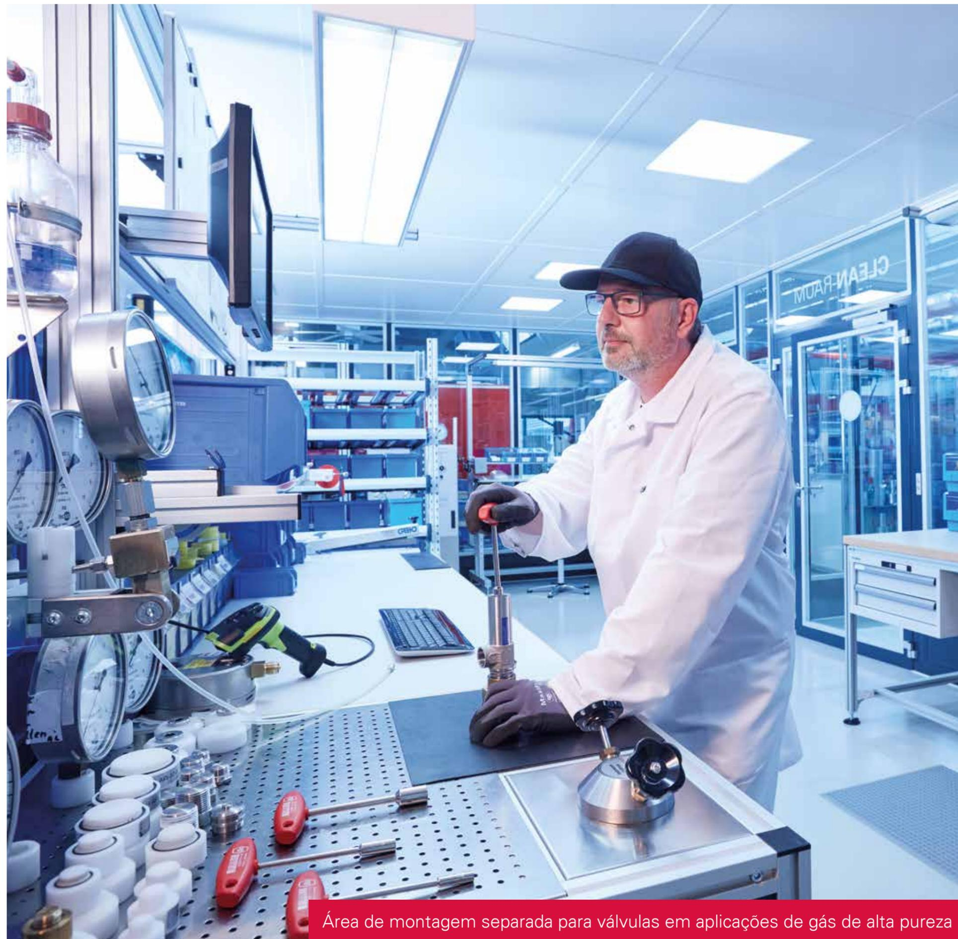
Área de montagem separada para válvulas em aplicações de gás de alta pureza
