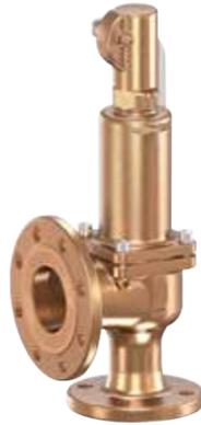
Essa série de válvulas de segurança também é feita inteiramente de materiais resistentes à corrosão. O corpo de bronze, a mola de aço inoxidável e todas as peças internas feitas de aço inoxidável são difíceis de superar em termos de resistência, especialmente em água agressiva e água salgada ou em uma atmosfera salgada.
