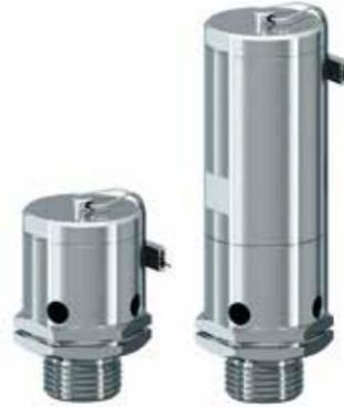
A válvula serve como uma válvula de ventilação para tubos, sistemas de tubulação, vasos e trocadores de calor nos quais a pressão não deve cair abaixo da pressão atmosférica.
