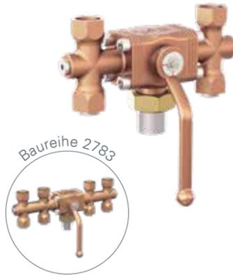
Wechselkugelhahn für den Aufbau von z.B. zwei Sicherheitsventilen in Kombination mit Berstscheiben zur Absicherung von Behältern für die Lagerung von tiefkalt verflüssigten Gasen.
