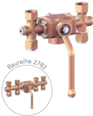
Wie bereits in der Edelstahl-Baureihe 2700 umgesetzt, verfügt auch der Rotguss-Wechselkugelhahn 2780 über eine Strömungsgeometrie mit sehr geringem Druckverlust. Die sichere Funktion der auf dem Wechselkugelhahn montierten Sicherheitsventile ist somit stets gewährleistet.
