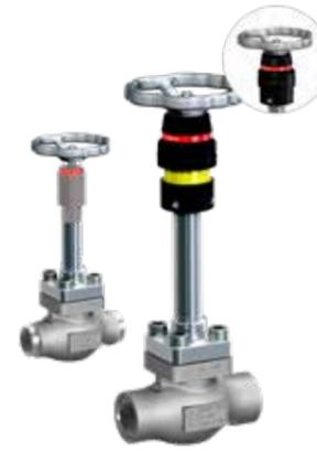
Hauptfunktion des Absperrventils 2140 ist das kontrollierte Öffnen und Schließen von Rohrleitungsabschnitten über den im Gehäuse integrierten Ventilsitz. Durch den Einsatz von hochwertigen Edelstahlwerkstoffen kann die Armatur für den tiefkalten Betrieb bei Temperaturen bis -196 °C eingesetzt werden. Für die Absperrventile liegt eine Zulassung nach DIN EN 1626 vor.
