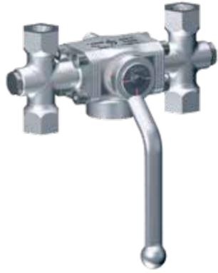
Die optimale Gestaltung der Strömungskanäle innerhalb des Wechselkugelhahns ermöglichen besonders hohe Durchflussleistungen. Dadurch sind die Strömungsdruckverluste zu den Sicherheitsventilen deutlich reduziert und eine sichere Funktion bleibt gewährleistet. Durch die Verwendung hochlegierter Edelstähle 1.4404 und 1.4408 wird eine hohe Widerstandsfähigkeit gegen innere und äußere Einflüsse erreicht.
