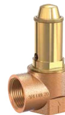
La soupape de sûreté à membrane de type 652 mFK-EPDM a été conçue spécialement pour la sécurisation de circuits de refroidissement fermés. La soupape entièrement métallique en bronze anticorrosif est destinée aux installations et fluides de refroidissement composés jusqu'à 100% de glycol.
