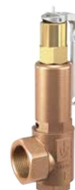
Soupape de sécurité hautes performances avec soufflet, en bronze de qualité anticorrosif. Dans les installations de chauffage avec des pressions différentes de 2,5 bars et 3 bars, l'utilisation de telles soupapes de sûreté est obligatoire. Le dimensionnement, à part pour les installations chauffées de manière indirecte, dépend de la puissance calorifique de la chaudière qu'il faut sécuriser.
