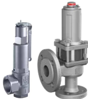
Ces soupapes de sécurité en acier inoxydable de la série 451, hautement résistantes à la corrosion et à la température, avec soufflet en acier inoxydable, répondent aux exigences les plus élevées en matière de résistance à la température et d'équipement. Pour la protection d'installations solaires et d'installations de chauffage urbain à sécurité non intrinsèque avec des températures supérieures à 200°C.
