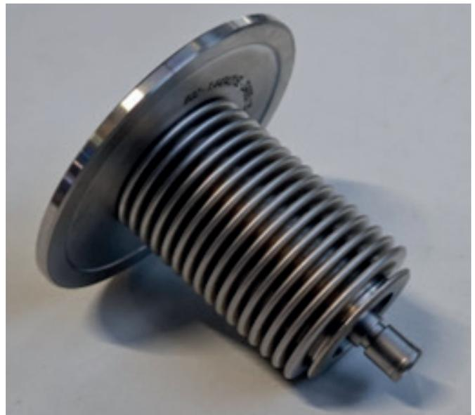
Der Faltenbalg kann nun gereinigt, auf Dichtheit geprüft oder ausgetauscht werden.
