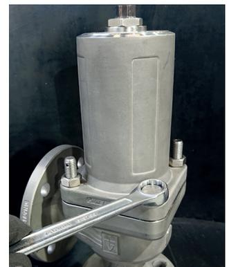
Verschraubung von Haube und Gehäuse.
