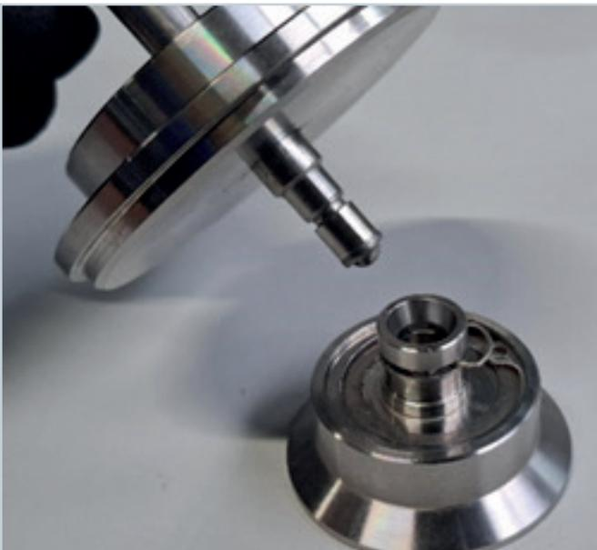
3.22 Spindel aus Kegel ziehen und ggf. Kugel aus Kegel entnehmen.
