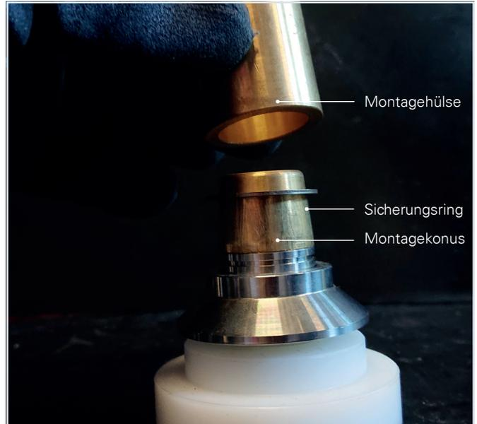
3.12 Sicherungsring in der Nut montieren.
