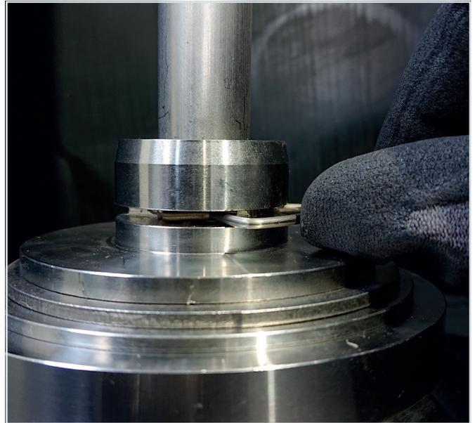
**ACHTUNG!** Bei der Faltenbalgausführung ist bei der Kegelabnahme darauf zu achten, dass der Balg nicht überdehnt wird (nicht am Balg ziehen).
