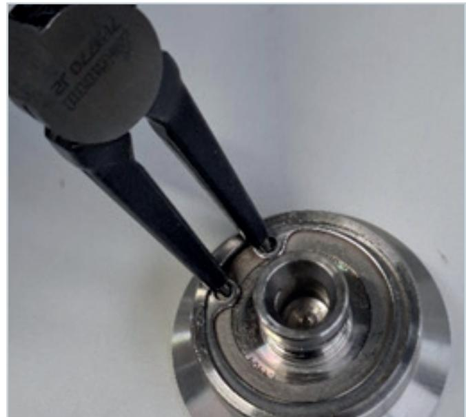
3.23 Kegel-Hubring-Baugruppe auf eine flache Unterlage stellen und Sicherungsring entfernen.
