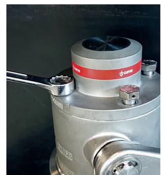
Verschraubung von Kappe mit Gehäuse mit und ohne Anlüftung.
