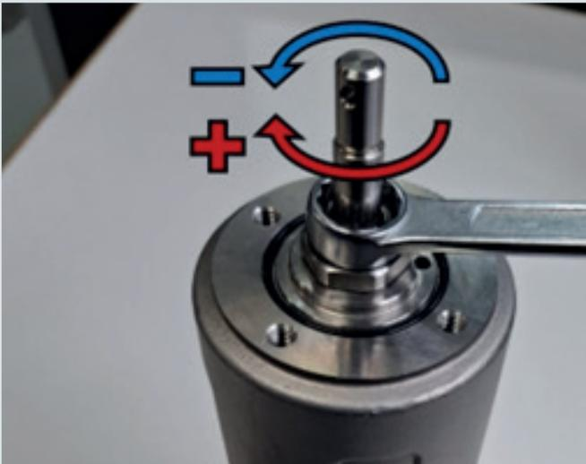
**Druckumstellung im zulässigen Druckbereich der eingebauten Feder gemäß V-0219 möglich: Hinweise in Kapitel 12 sowie am Ende dieses Kapitels beachten.**
