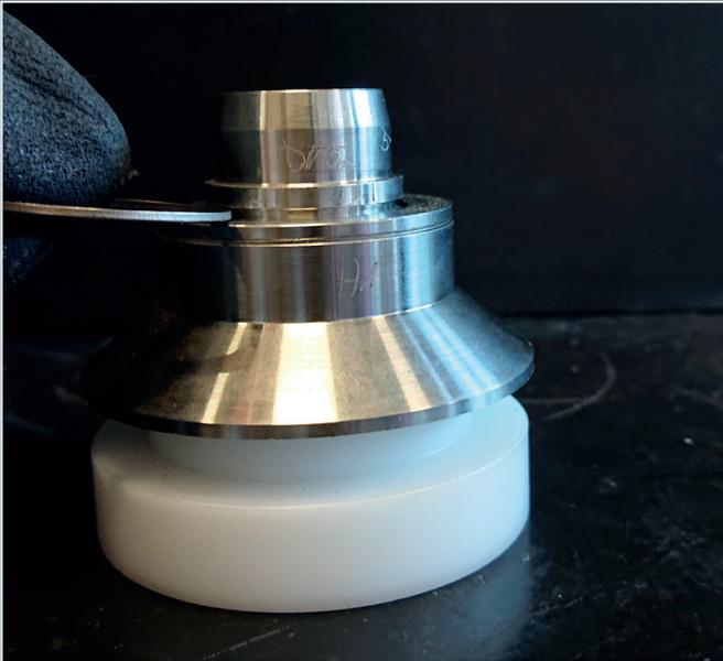
3.9 Kegel auf Montageauflage setzen und Hubring auf Kegel montieren.
