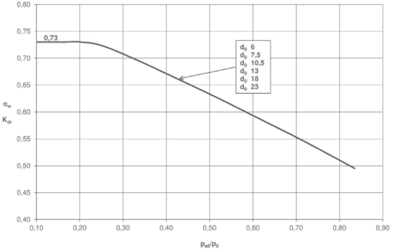
$$\frac{p_{a0}}{p_0} = \frac{\text{Contre-pression bar(a)}}{\text{Pression de décharge bar(a)}} \quad p_{atm} = \text{pression ambiante ou pression atmosphérique} = 1,01325 \text{ bar(a)}$$
