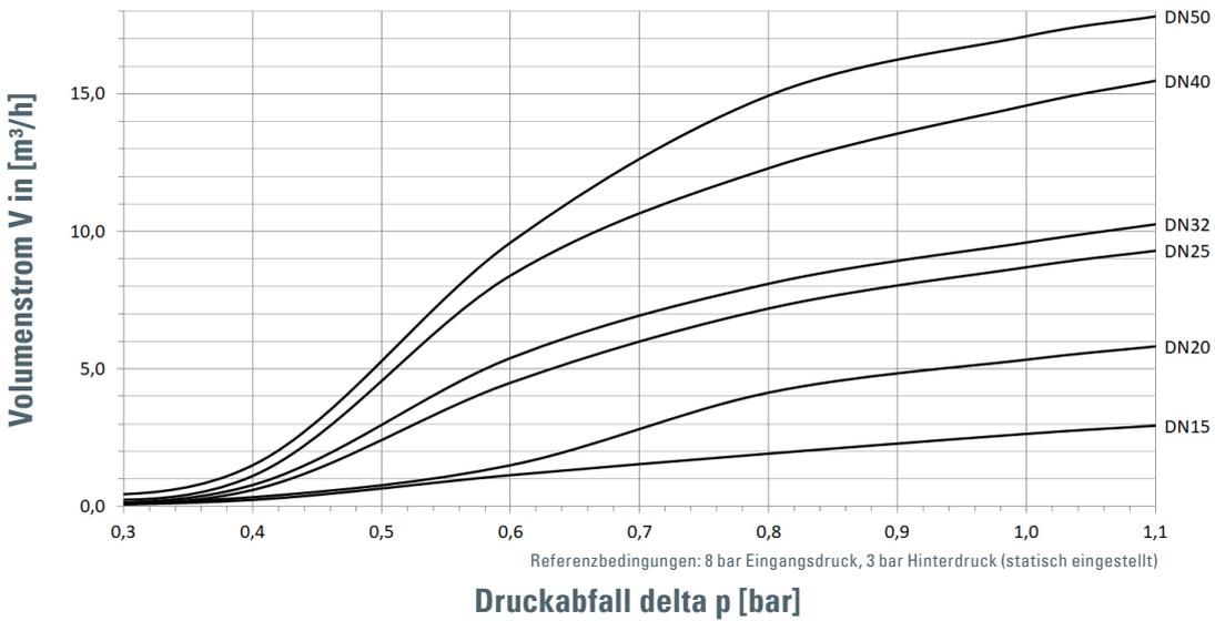
Auslegung über Durchflussgeschwindigkeit
